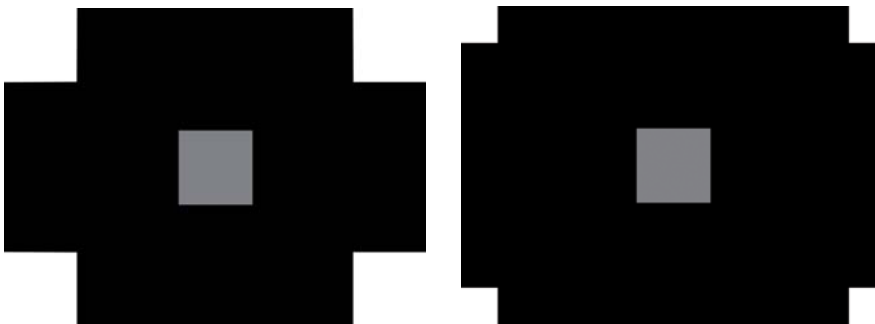
Bild 5. Prüfmuster mit Feldern maximaler Leuchtdichte, die verhindern, dass die Leuchtdichte der Hinterleuchtung abgesenkt wird (backlight dimming). Die Größe dieser Felder kann auf wenige Bildelemente beschränkt sein.
