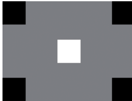
Bild 4b. Das zentrale helle Feld wird nicht über horizontales und vertikales Übersprechen der schwarzen Blöcke beeinflusst.
